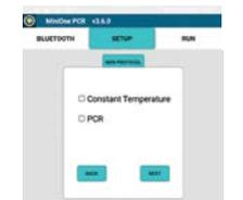
Sélectionnez le mode à température constante pour les digestions et les extractions d'ADN, ou le mode PCR pour l'amplification de l'ADN.
