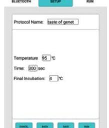
Mettre en place des protocoles de température constante pour incuber des échantillons à 0-99°C à l'aide d'une interface simple et intuitive.
