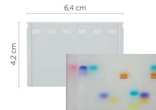
A utiliser avec la séparation des colorants. Plaque de plastique de couleur gris argenté avec texture sur la zone du puits.
