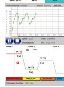
L'écran d'exécution affiche une lecture en temps réel, continuellement mise à jour, de la température, du cycle en cours, de l'étape en cours et du temps écoulé.
